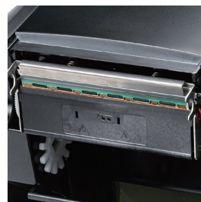
"Twin-Sensor"-Technologie erlaubt den Einsatz unterschiedlichster Etiketten
