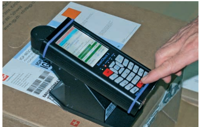
Prüfung von Barcodes im Warenausgang
